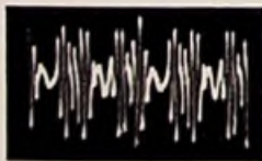
Bild 4. Große Intermodulationsverzerrung bei einem minderwertigen Tonabnehmer
