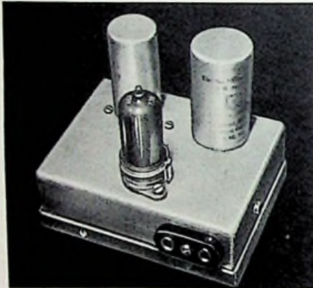
Bild 1. Ansicht des Mischverstärkers mit einer Doppelröhre
