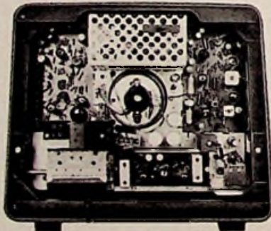
Bild 2. Rückansicht des Empfängers; rechts und links oben erkennt man deutlich die Platinen mit den Einzelteilen
