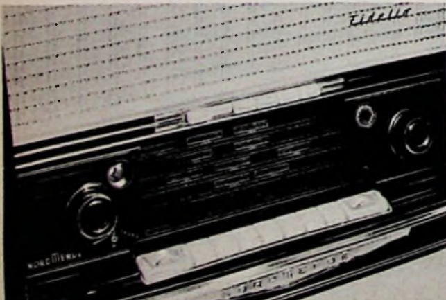
Bild 1. Das Gesicht des modernen Exportempfängers mit international beschrifteter Skala, Klangregister, Tastenreihe für Wellenbereiche und Phono sowie Kurzwellenlupe
