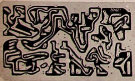
Bild 3. Aufsicht auf die gedruckte Verdrahtung einer Platine
