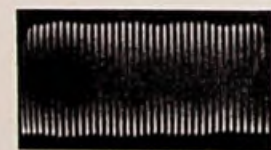
Bild 4. Große Intermodulationsverzerrung bei einem minderwertigen Tonabnehmer
